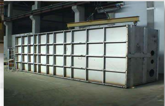
Inox Tank Fabrication 8,5 x 3,0 x 2,2 mt
